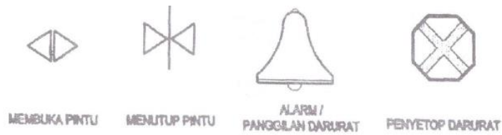
Gambar : Standar simbol panel dibuat timbul
