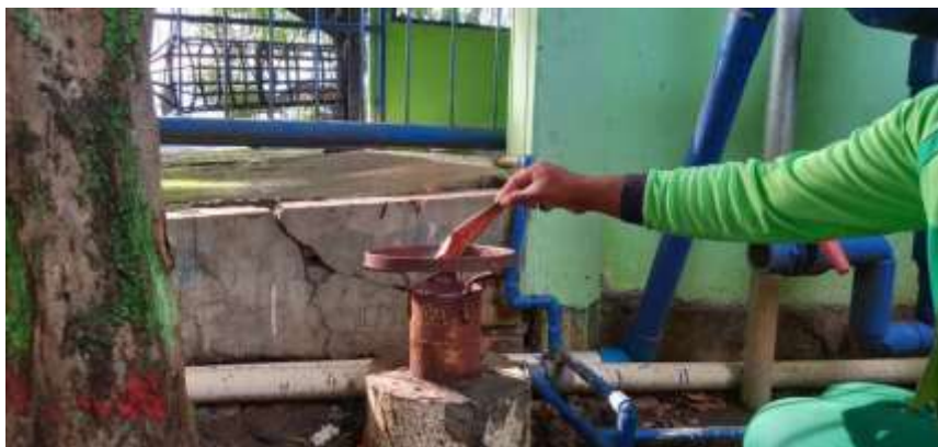
Gambar 4.1.5 Pembuktian Gas Metan Mudah Terbakar
