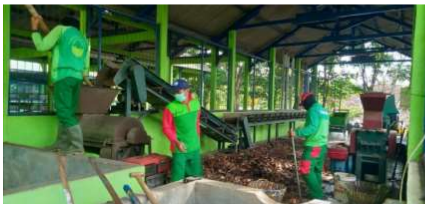
Gambar 4.1.7 Proses Penghancuran Dedaunan Untuk Composting
