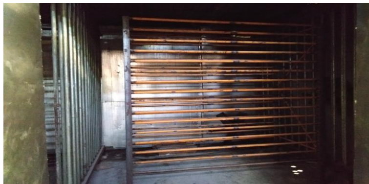
Gambar 4.13 Mesin Oven (proses pengeringan)
