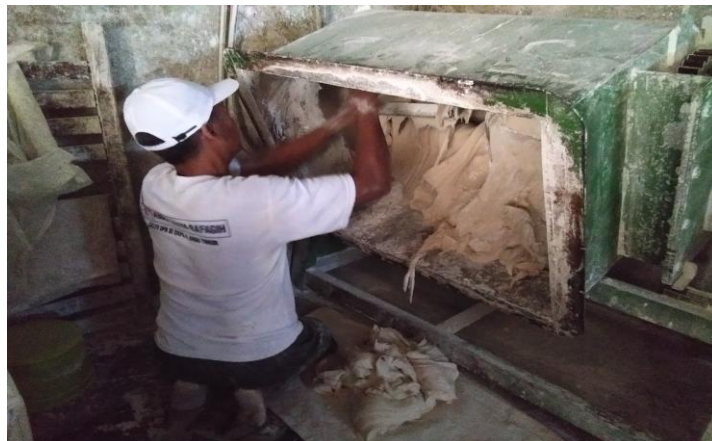
Gambar 4.9 Mengambil adonan kerupuk di mesin molen
