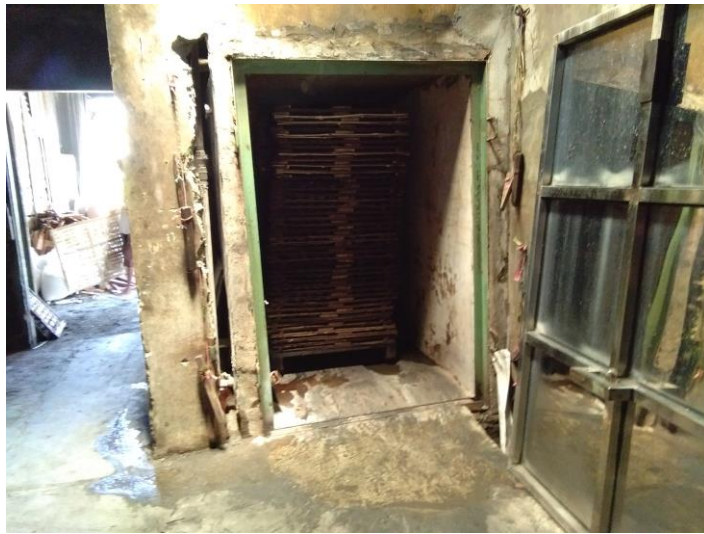
Gambar 4.12 Proses Mengukus Kerupuk
