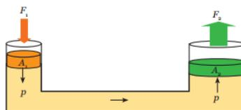
Gambar 2.2 Model dongkrak hidrolik
