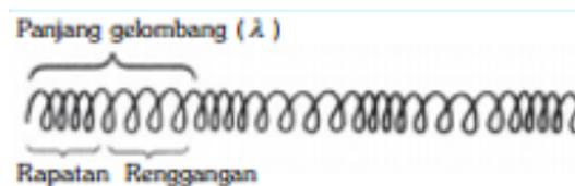
**Gambar 2.3 Bentuk Gelombang Longitudinal Pada Slinky**
