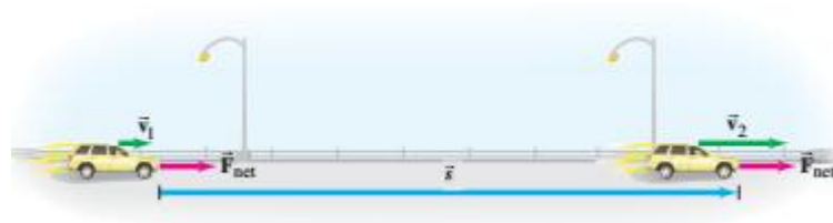
Gambar 2.7 Gaya total konstan \vec{F}_{net} mempercepat mobil dari laju v_1 sampai v_2 sepanjang jarak s
