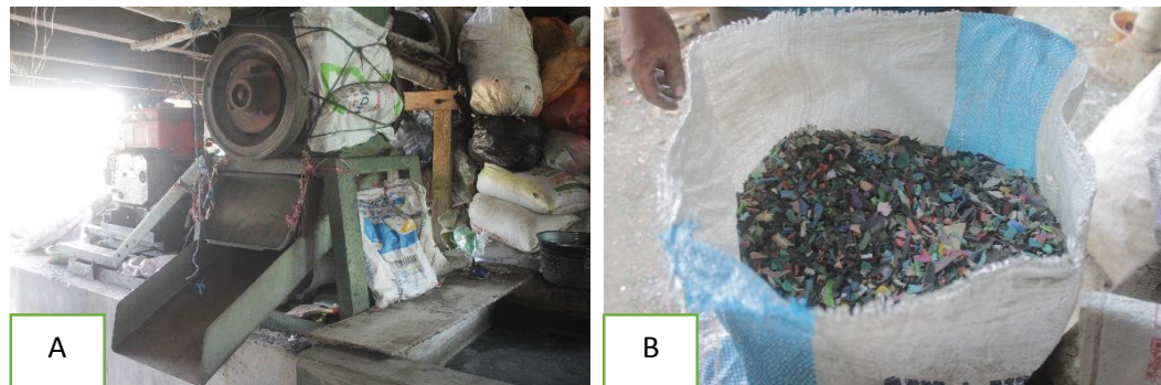
Gambar 4.15 (A)Mesin Penggiling Sampah (B)Flakes 158
