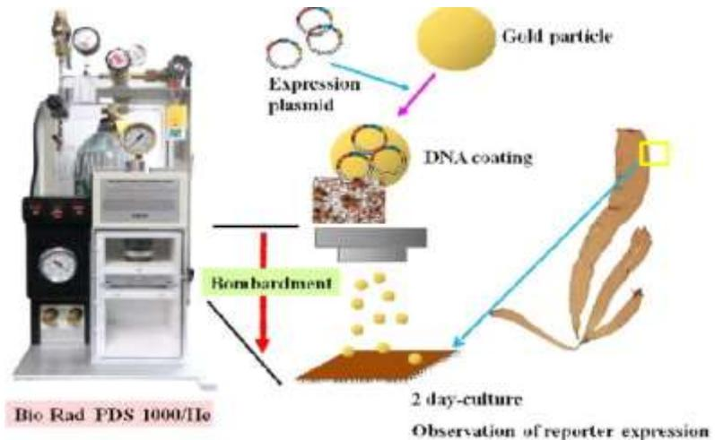
Gambar 6.5 Mekanisme transformasi DNA metode penembakan partikel (Kavipriya et al. 2019)
